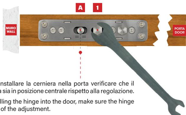
**Nota:** Prima di installare la cerniera nella porta verificare che il perno della cerniera sia in posizione centrale rispetto alla regolazione.
