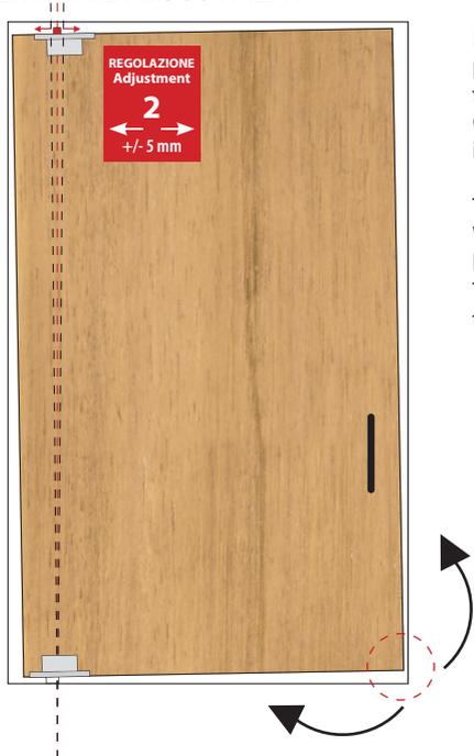
La vite a testa esagonale **2** permette di regolare la perpendicolarità della porta rispetto al pavimento e al soffitto. A regolazione terminata **girare in senso orario** la vite testa esagonale **1** fino a fondo corsa per bloccare definitivamente il perno in posizione tutta alzata. Queste regolazioni si effettuano con la speciale chiave esagonale fornita in dotazione e permettono il corretto allineamento della porta installata.
