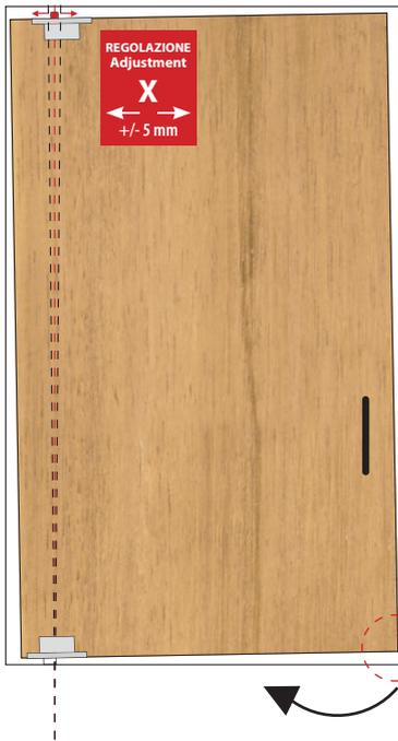
La regolazione **X** permette di regolare la perpendicolarità della porta rispetto al pavimento e al soffitto. A regolazione terminata **girare in senso orario** la vite **1** fino a fondo corsa per bloccare definitivamente il perno in posizione tutta alzata. Queste regolazioni si effettuano con la speciale chiave esagonale fornita in dotazione e permettono il corretto allineamento della porta installata.
